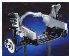
●サスペンションの構造はモデルによってさまざまだが、その構成はショックやロアアームなど、基本的な部分は同じ。
